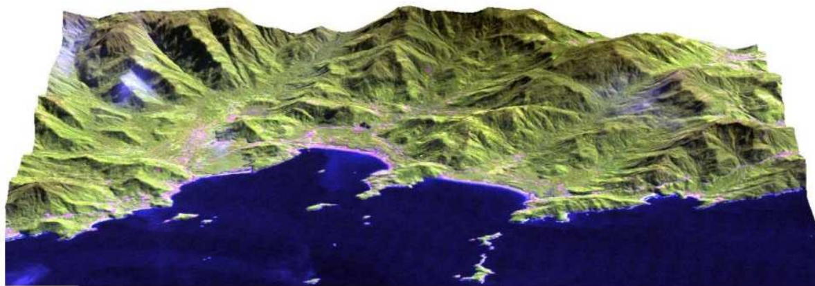
Fig. 2. Imagem da área de estudo em visão tridimensional, resultado de integração de imagem Landsat 7- ETM+ com modelo numérico de terreno SRTM-30 metros.
